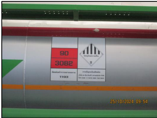
ภาพที่ 2.39 ป้ายแสดงรายละเอียดเกี่ยวกับการขนส่งที่ติดที่ตัวรถบรรทุกขนส่งของเสียที่เป็นของเหลว
